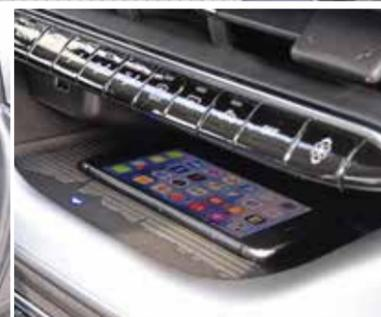
Die praktische Ablage wird für 150 Euro zur induktiven Ladefläche für Smartphones
